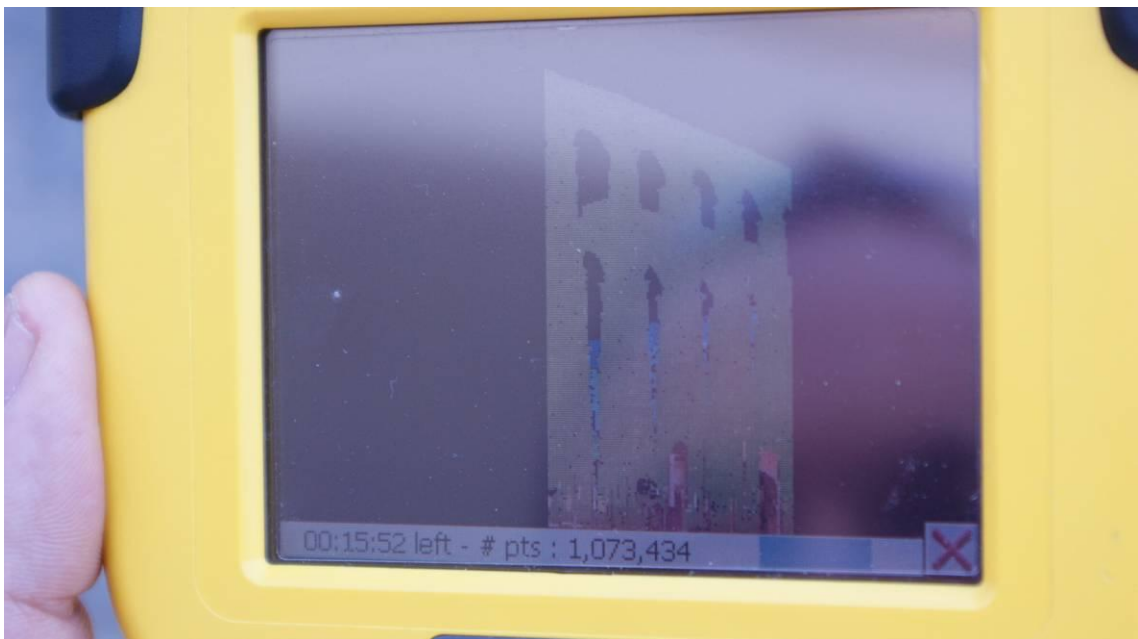
Ilustración 32 Fotografía toma de puntos del escáner 3d.
